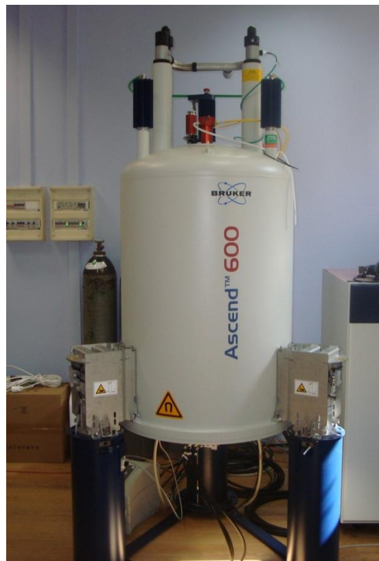
Magnes nowego spektrometru 600 MHz w trakcie instalacji
