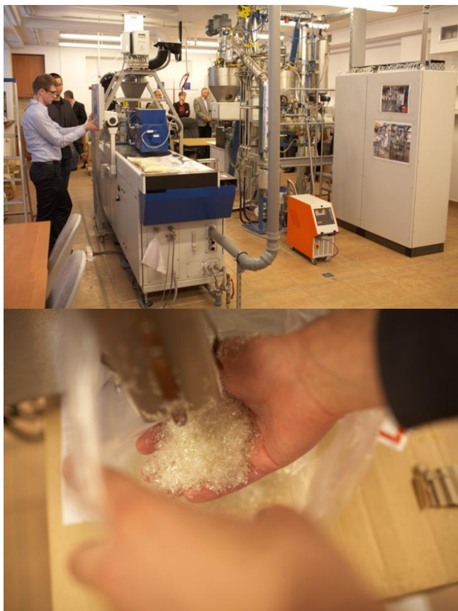
W Politechnice Warszawskiej zaprojektowano i wybudowano modelową instalację badawczą do wytwarzania polilaktydu.
