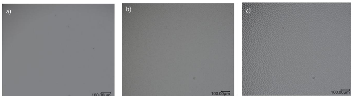
Rysunek 26. Zdjęcia mikroskopowe wodnych roztworów polimerów na przykładzie polimeru PC46 w temperaturze przed przejściem fazowym (a), w temperaturze zmętnienia (b) oraz w temperaturze wyższej niż temperatura zmętnienia (c). [zaczepnięte z A3]
