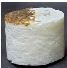
Rysunek 7. Krople wody i olej surowy na powierzchni gamma-naświetlanego CNC-MTMS
